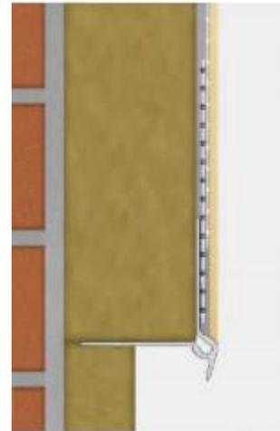
Particolare montaggio modula P3 come elemento di transizione
